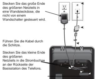
Stecken Sie das eine Ende des Telefonkabels in eine Telefonbuchse oder einen DSL-Filter.
