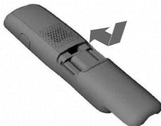
Richten Sie die Abdeckung lateral mit dem Batterie aus und schieben Sie sie dann aufwärts, bis sie einrastet.
