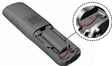
1. Stecken Sie die Klinke des Akkupacks fest in den Anschluss im Batteriefach des Handapparates ein. Das mitgelieferte Akkupack wie angezeigt einlegen.
