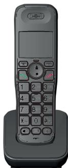
2. Laden Sie den Handapparat, indem Sie ihn mit der Vorderseite nach vorn in das Ladegerät platzieren. Wenn der Handapparat im Ladegerät geladen wird, ertönt ein Pfeifton.
