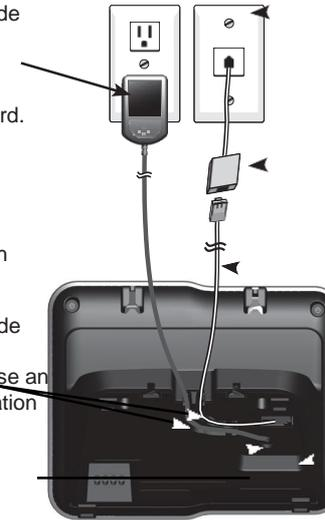
Schließen Sie das eine Ende des Telefonkabels in eine Telefonbuchse oder einen DSL-Filter.
