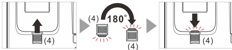
Drehen Sie den Hörerhaken (4) in der Hörerhalterung um **180°**, damit der Hörer eingehängt werden kann.
