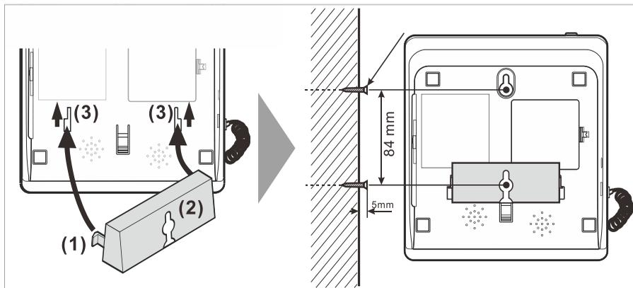
Insérez les pattes de guidage (1) du support mural (2) dans les fentes (3) situées à l'arrière du téléphone. Faites glisser le support mural (2) de 10 mm vers le haut jusqu'à ce qu'il s'enclenche de manière audible.
