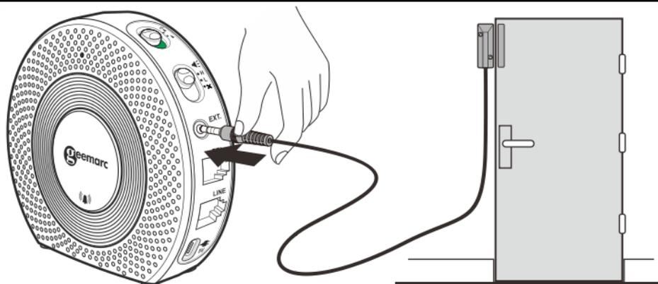
El AC110 es compatible con dispositivos externos como alfombras de caída y otros tipos de sensores que se pueden conectar al AC110 mediante la toma de jack "EXT". Una vez conectado, el dispositivo enviará una señal al receptor cada vez que se active.
