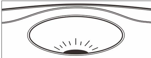
1. **LED Azul** parpadea en sincronía con la intensidad de campo del LED en la parte frontal.
