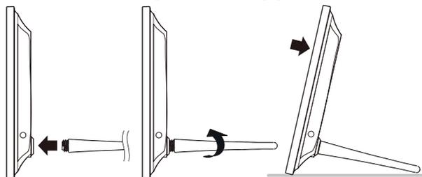
Le support est connecté à l'arrière du produit. Veuillez mettre le support avant de le poser sur la table, retirer le support de la fente avant de le relever. Veuillez-vous reporter à l'illustration ci-dessus.
