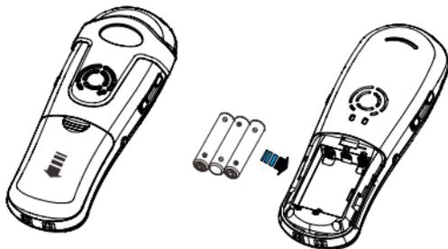
3. Zum Schließen Batterieabdeckung bitte soweit nach oben schieben, bis sie einklickt.
