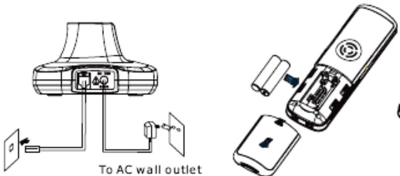
Legen Sie die Akkus in das Batteriefach des Mobilteils ein. Benötigt werden zwei AAA Nickel-Metallhydrid-Akkus (NiMH). Diese liegen Ihrem Telefon bei. Schieben Sie den Batteriefachdeckel in Pfeilrichtung und entfernen Sie ihn. Achten Sie beim Einlegen der Batterien auf die richtige Polarität, wie auf dem Mobilteil dargestellt. Schließen Sie den Batteriefachdeckel, indem Sie ihn an der Rückseite des Mobilteils hochschieben, bis er einrastet.
