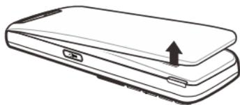
Desmunte la batería (si ya existe batería en el interior).
