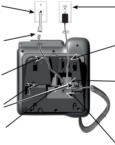
Stecken Sie das große Ende des größeren Netzteils in eine Wandsteckdose, die nicht von einem Wandschalter gesteuert wird.
